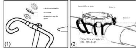
Usar los elásticos para fijar el soporte al manillar o al tubo vertical con los elásticos.
